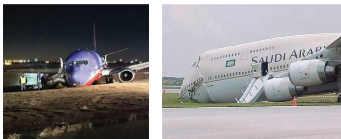
1. Skutki niedostatecznej nośności naturalnej nawierzchni lotniskowej [6,7]
